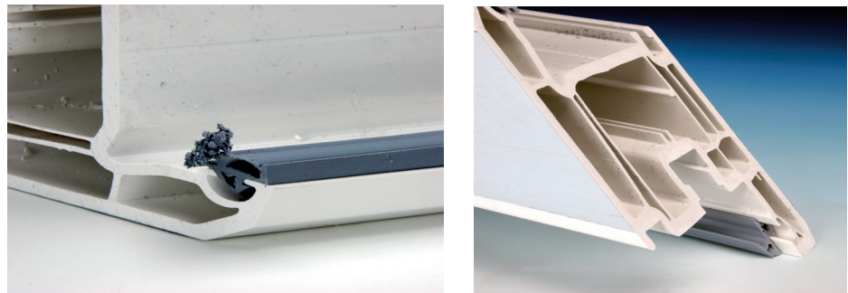
Abb. 4: Fehler beim Verarbeiten von Dichtungen (v.l.: Dichtung ausgefranst bzw. zu kurz) | Bilder: Veka
